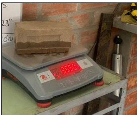
Figura 5: Ensayo de Absorción
