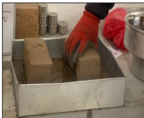
Figura 5: Ensayo de Absorción
