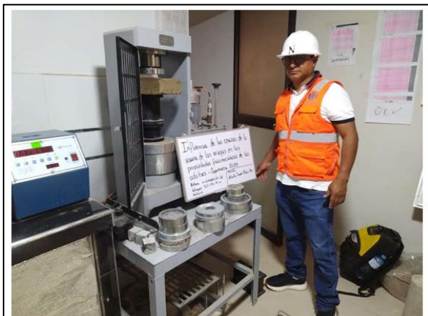
Figura 4: Prueba a compresión Axial por Unidad
