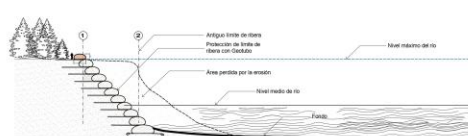
REPRESENTACIÓN DE LA PROTECCIÓN DE LA MARGEN DERECHA, EROSIONADA POR EL RÍO
