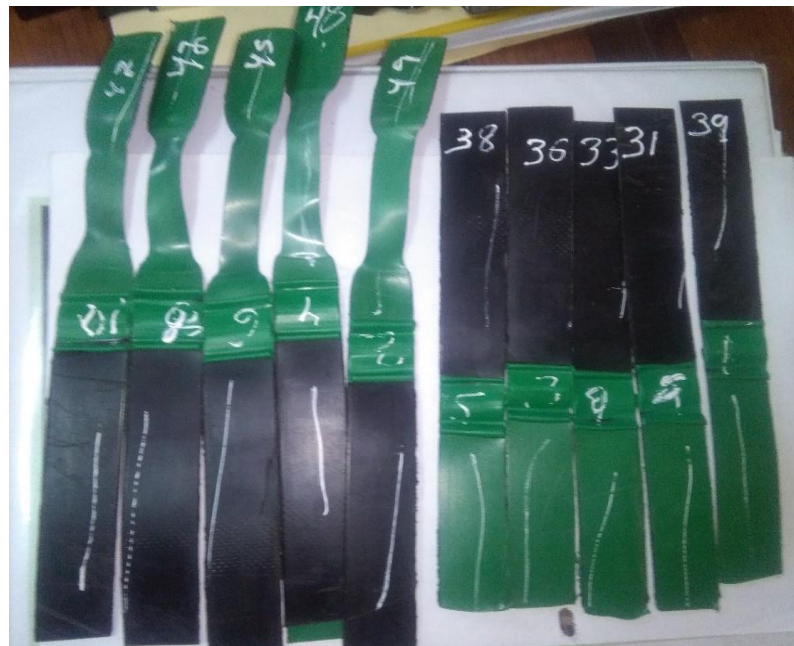
Figura 04 Prueba destructiva de extrusión
