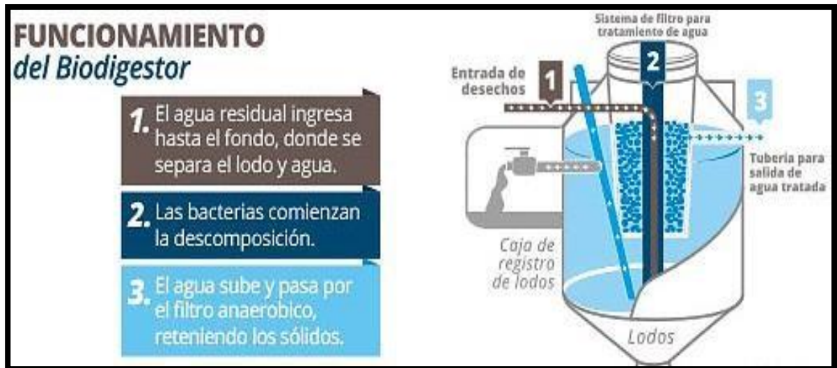
FIGURA N°06: FUNCIONAMIENTO DEL BIODIGESTOR
