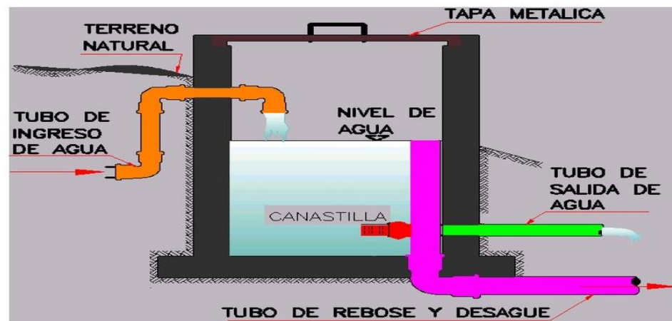
FIGURA N°10: PARTES DE LA CAMARA ROMPE PRESION
