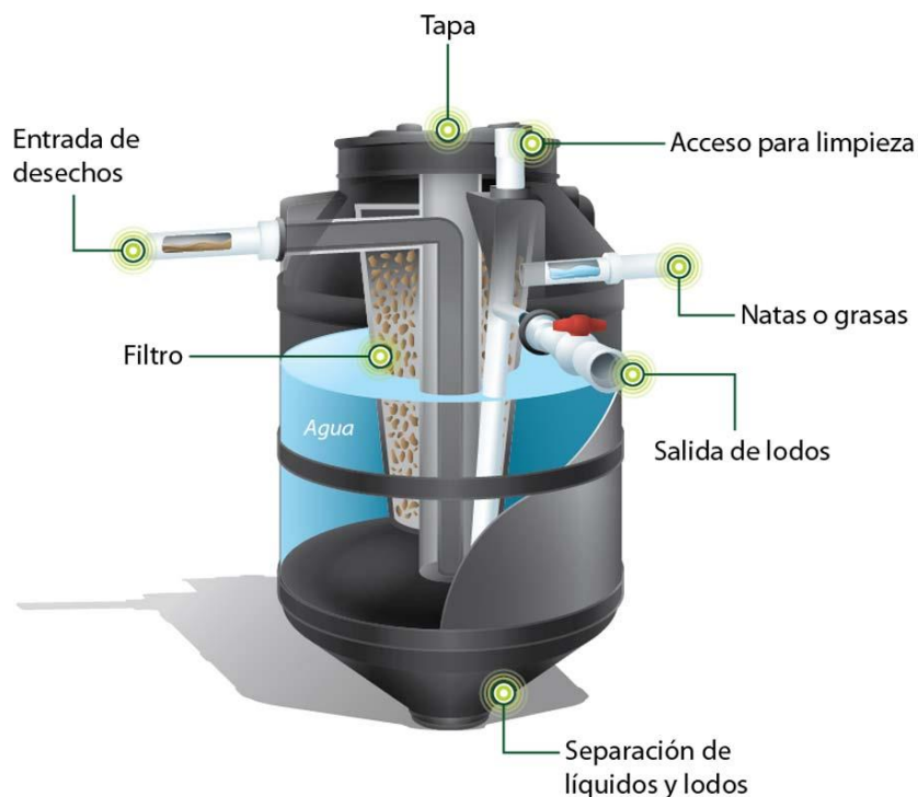
FIGURA N°09: Partes Del Biodigestor
