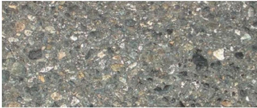
Figura 15: Pulimiento de agregados. Fuente: Corros, Maylin. Urbaez, Ernesto. Corredor, Gustavo (2009)
