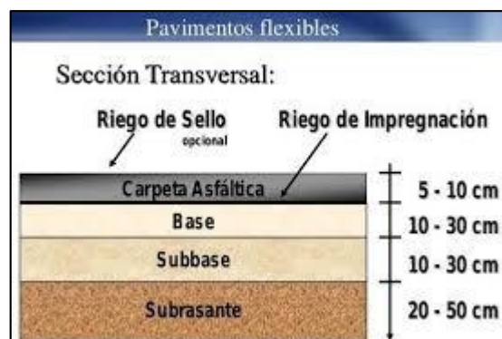
Figura 1. Sección Transversal Pavimento Flexible
