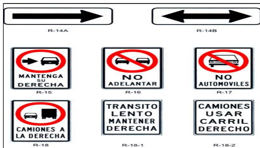
Figura 18: Señales de sentido de circulación
